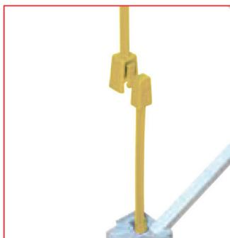
Não levante a estrutura pelos conectores, mas pela estrutura
