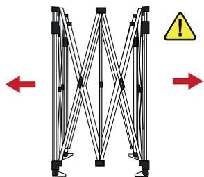
Retire a estrutura do saco e estique-a parcialmente puxando para fora
